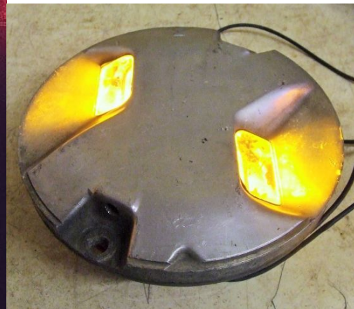
Lâmpada Unidirecional. Pouca visibilidade da pista quando voando fora de seu alinhamento.
